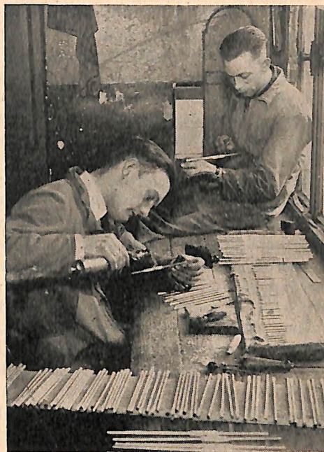
Met electr. soldeerbout worden de labiums bevestigd.
